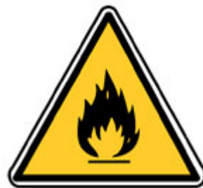
Matières inflammables ou haute température (1)
